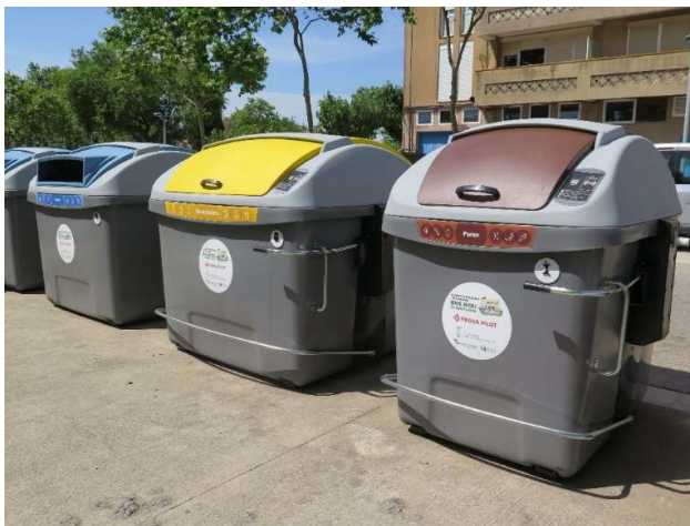
Figura 2. Contenidors amb sistema de tancament i identificació. Font: Ajuntament de Santa Margarida i els Monjos, 2022.
