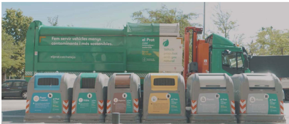
Figura 2. Nous contenidors de càrrega bilateral amb sensor d'emplenat i camió amb sistema de pesatge. Font: Ajuntament del Prat del Llobregat, 2021.
