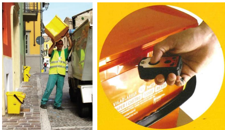
Figura 4. Sistema de lectura a través dels elements a bord del vehicle de recollida (esquerra); i, a través d'un lector manual (dreta) a Vilablareix. Font: ID Waste, 2017.
